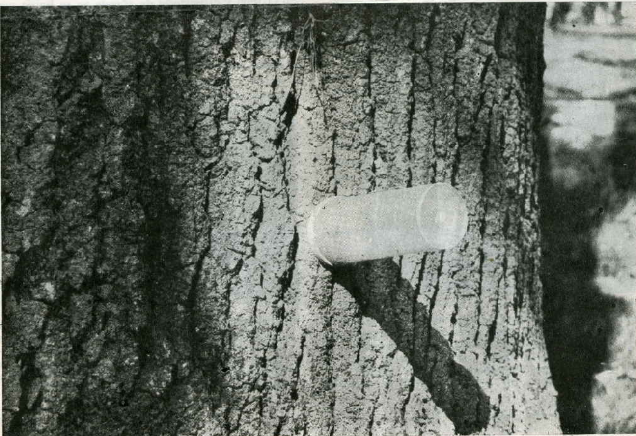
Fig. 5. — Vista del envase insertado en la tapa clavada en la corteza y perforada en el centro para no detener la salida de los adultos de « Platypus sulcatus ». (Aumento aproximado: mitad del tamaño natural). Fotografía A. Caramés.
