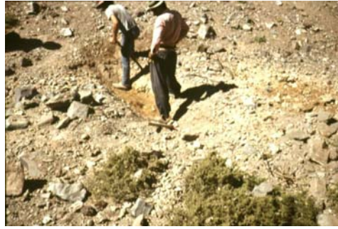
Figura 3.8: hallazgo de manifestación mineral cubierta, puesta en evidencia en la zanja abierta a pico y pala.
