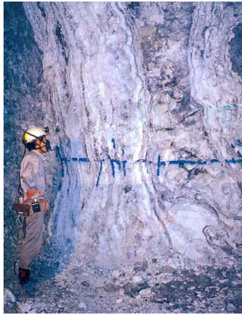
Figura 2.1: Yacimiento con forma de veta vertical. Mina Hishikari (oro y plata) de Japón. La roca oscura, a ambos lados, es la roca de caja
