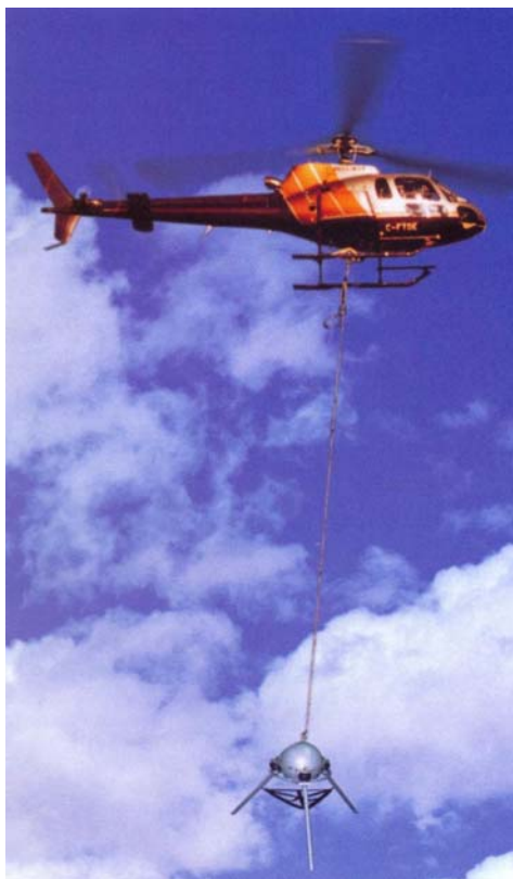
Figura 3.11 - Prospección gravimétrica desde un helicóptero
