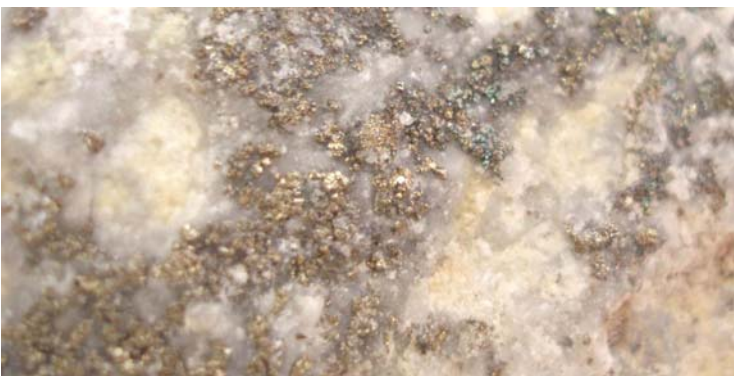
Figura 4.8: Sulfuros metálicos diseminados en una roca volcánica de color claro
