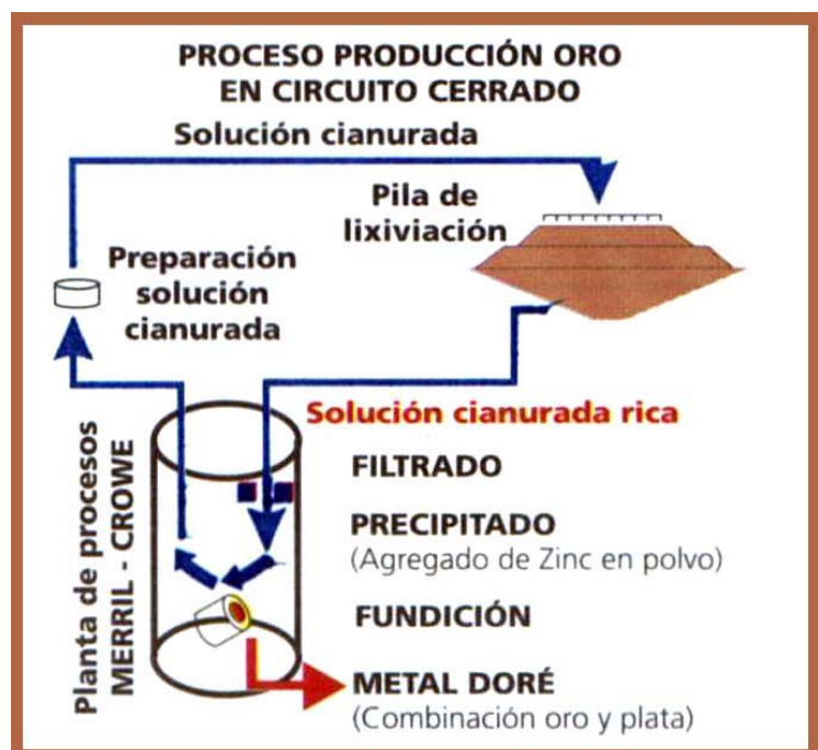
Figura 6.14: Esquema de la circulación en circuito cerrado de la planta de tratamiento de la mina de oro Veladero, San Juan.
