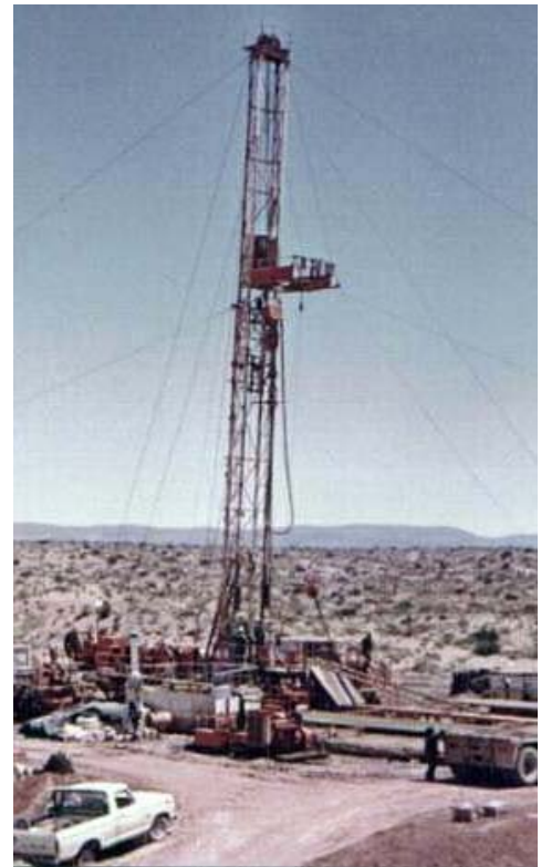
Figura 3.13: Perforación con recuperación de testigos a más de 1.000 m de profundidad
