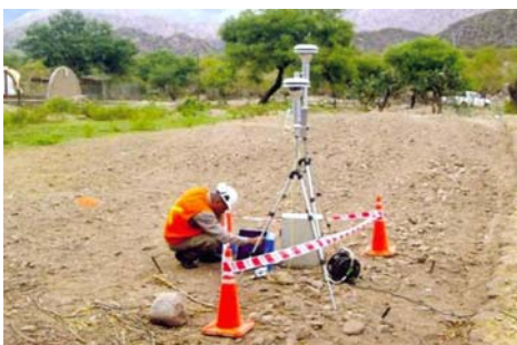
Figura 6.6: Equipo para monitorear la cantidad de polvo en suspensión en el aire
