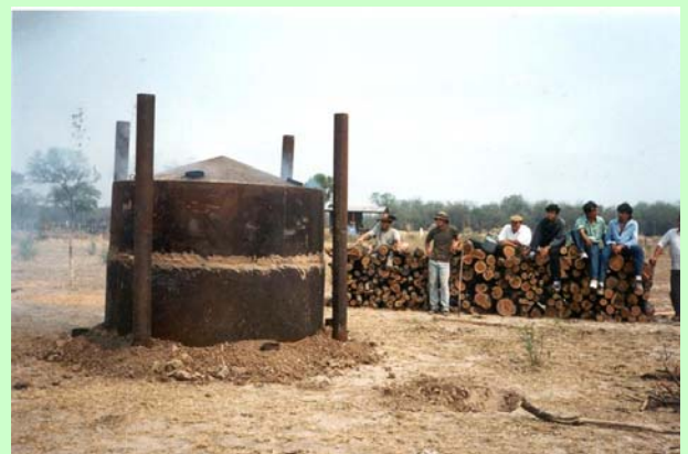
Fig. 18. Horno metálico para la producción de carbón construido por TeknyCampo. Demostración y capacitación realizada en Bartolomé de Las Casas, Formosa, en 1995.
