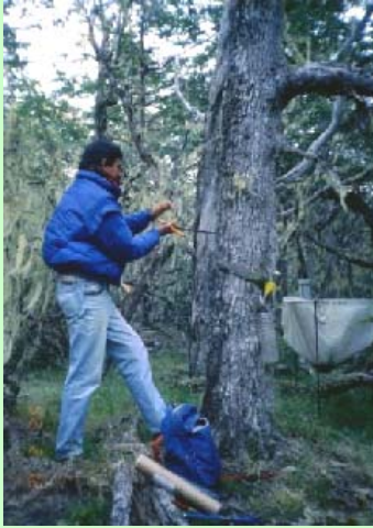
Fig. 45: Uso de barreno forestal para obtener tarugos del tronco del árbol, en éste caso un ñire, y estimar su edad y tasas de crecimiento en diámetro; en la foto MD Barrera.
