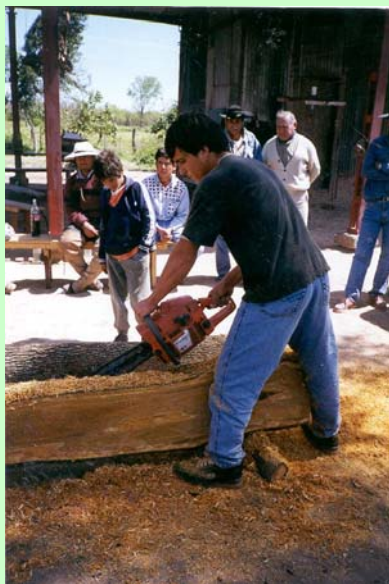
Fig. 19: Demostración de la producción de tablas tipo “aserrío” con motosierra, desarrollada en el marco de la capacitación realizada en Bartolomé de Las Casas, Formosa, en 1995.. toneladas, descartando el resto por presentar diámetros no aserrables (menores a 20 centímetros) y/o mala
